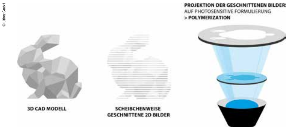
Abb. 2: Schematische Darstellung des Strukturierungsprozesses: Das CAD-Modell (links) wird virtuell in Schichten geschnitten (Mitte) und über eine dynamische Maskenbelichtung („Digital Light Processing“, DLP) wird das Material Schicht für Schicht strukturiert
