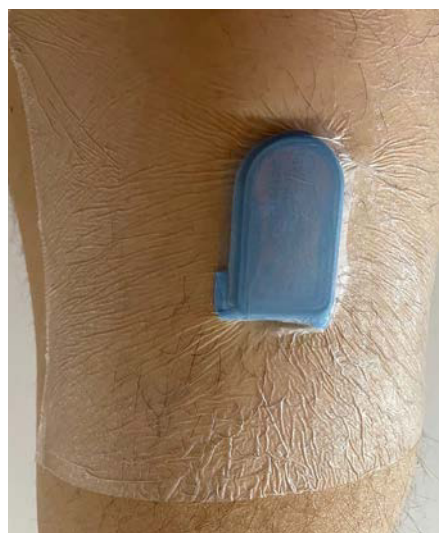
Abb. 1: Angebrachter activPAL™ an einem linken Oberschenkel. Die kompakte Bauform ermöglicht eine gute Compliance bei den Messungen
