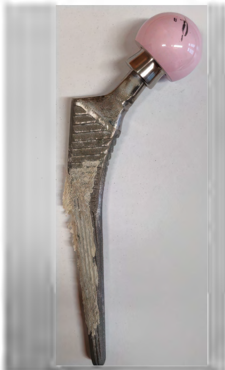
Abb. 1: Hüftprothesenschaft mit keramischem Kopf und Universal-Kopf-Konus-Adapter
